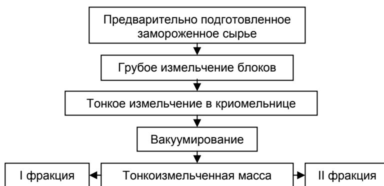
Рис. 1. Принципиальная схема разделения сырья на фракции
